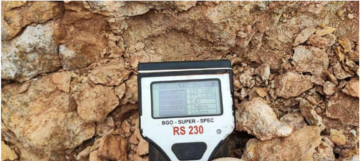
Figura VIII.1.20. Proyecto El Relincho Sur: Medición con radiómetro portátil en la zonas de anomalías de cobre y uranio.
