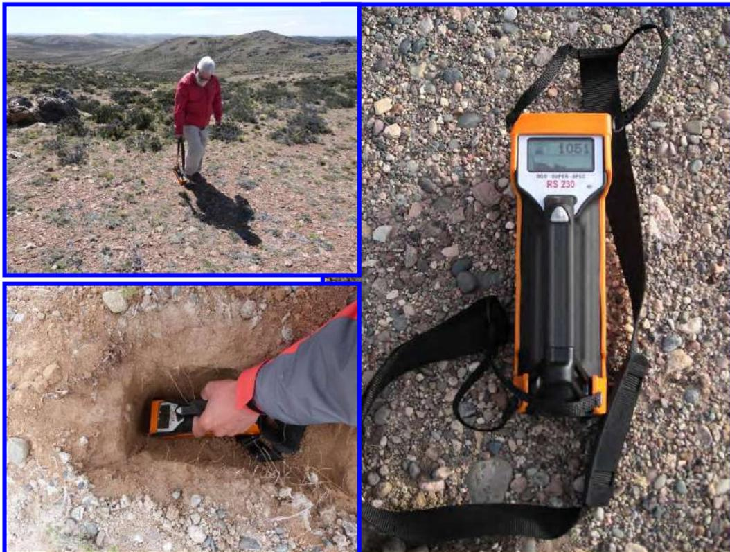
**Figura VI.1.** Radioespectrómetro RS-230 BGO Súper-SPEC
