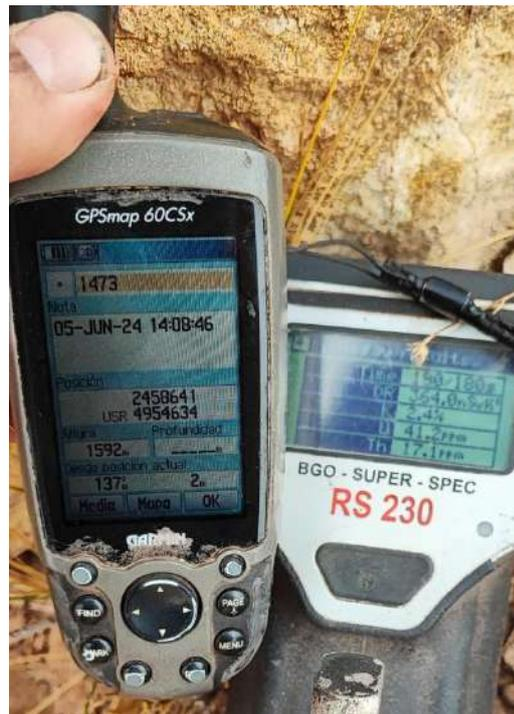
Figura VIII.1.21. Proyecto El Relincho Sur: Medición de radiómetro en la zona de anomalía de cobre y uranio. En esta locación, el radiómetro indicó 41,2 ppm de uranio y el posterior análisis geoquímico, 39,7 ppm, evidenciando la precisión de las medidas radimétricas de campo.
